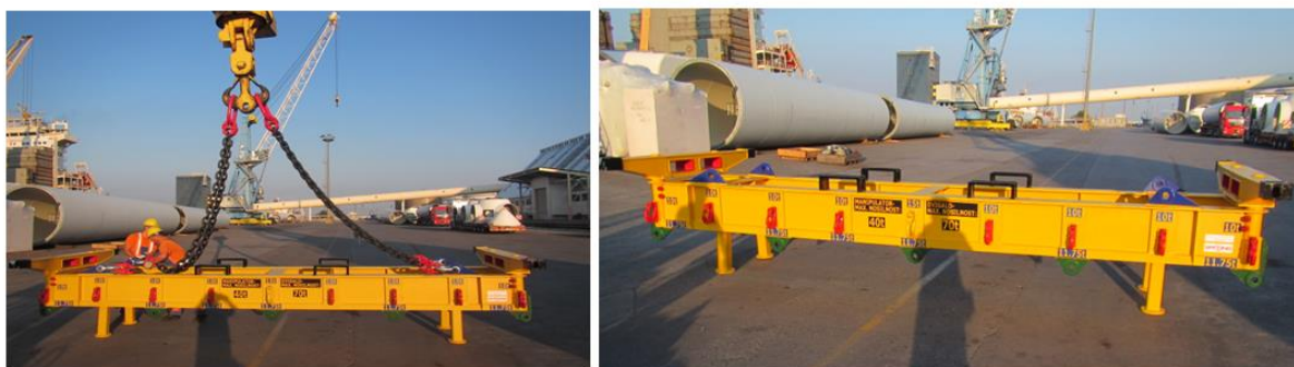
Slika 2: Obstoječi »podoben« distančni okvir, kateri se uporablja na terminalu za generalne tovore
